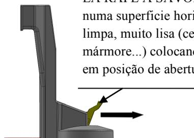
**3-** Mantenha a ventosa do pé em contacto com a superfície e bloqueie o pé carregando na alavanca até à sua posição de fecho.
