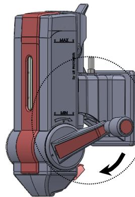
**2-** Tourner la manivelle toujours dans le même sens clapet fermé pour accumuler les flocons de savon à l'intérieur du bec de la râpe.
