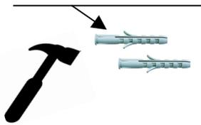
3- Percer avec un forêt de D 6 mm les 4 trous à la position des repères
