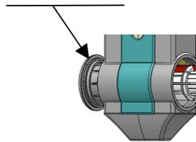
**1**– Retirer le cache manivelle à l'aide d'un petit tournevis et dévisser la vis
