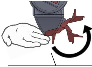
**1-** Ouvrir le clapet en poussant vers l'arrière jusqu'à sa position haute.
