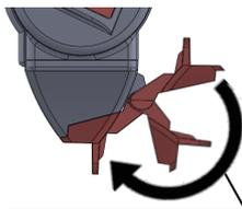
**1-** Fermer le clapet en tirant vers l'avant jusqu'à sa position de fermeture.
