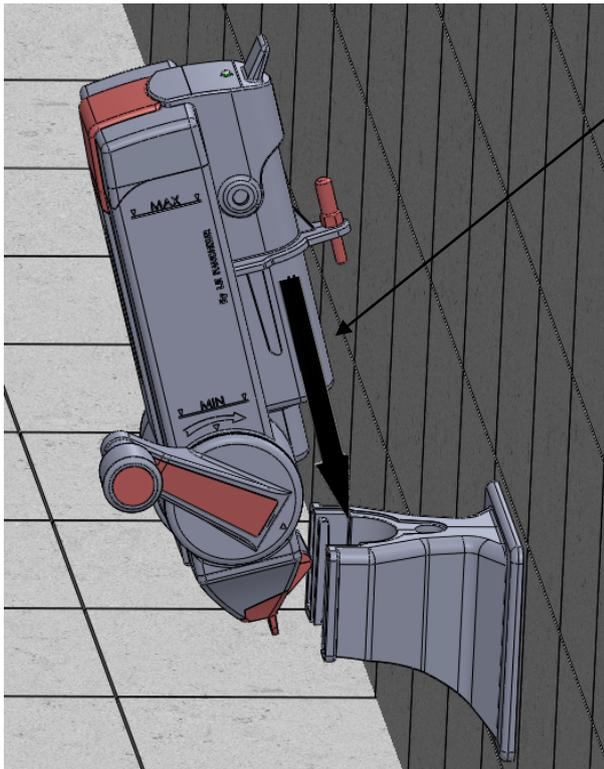
6- Incliner la râpe de 15 degrés avant de l'insérer dans les guides du support mural
