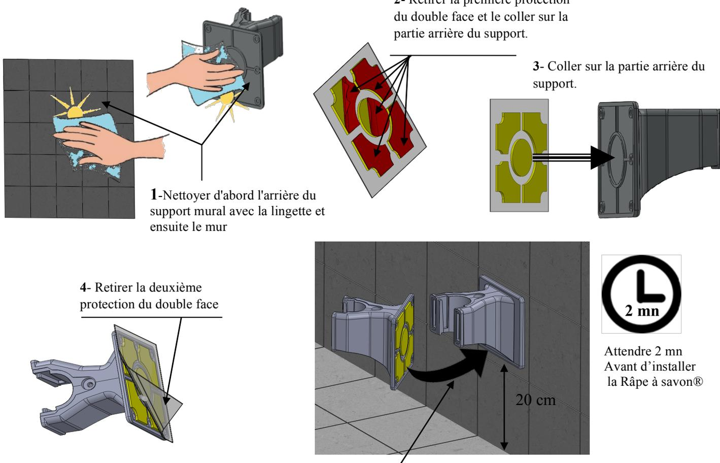
5-Coller le support horizontalement sur le mur en appuyant fermement et ensuite laisser sécher 2 minutes avant installation de la râpe.
