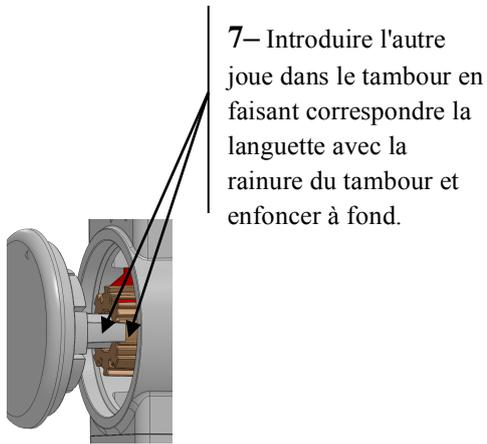
**7**– Introduire l'autre joue dans le tambour en faisant correspondre la languette avec la rainure du tambour et enfoncer à fond.
