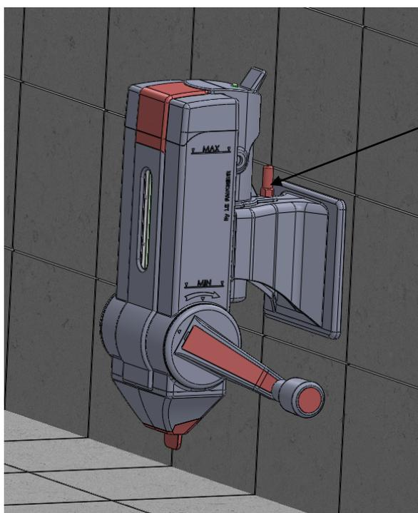
8-Serrer modérément la vis avec la main ou la clé (option) . La Râpe est maintenant installée.
