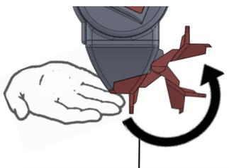
**3-** Ouvrir le clapet en poussant avec le côté de l'index sur la languette de manœuvre du clapet, paume vers le haut et doigts joints.
