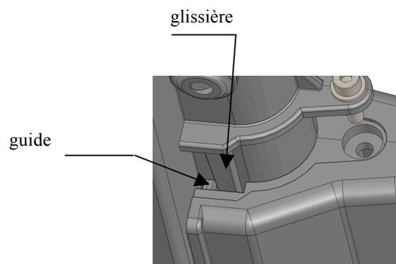
7- Râpe inclinée à 15 degrés : Insérer ensuite les glissières de la râpe dans les guides du support et enfoncer à fond . Serrer modérément la vis à la main ou avec la clé (option)
